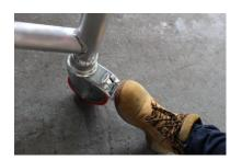
**5.** PLACE THE LADDER INTO POSITITION USING THE LOCATION RINGS. ENSURE HOOKS ARE SECURED
